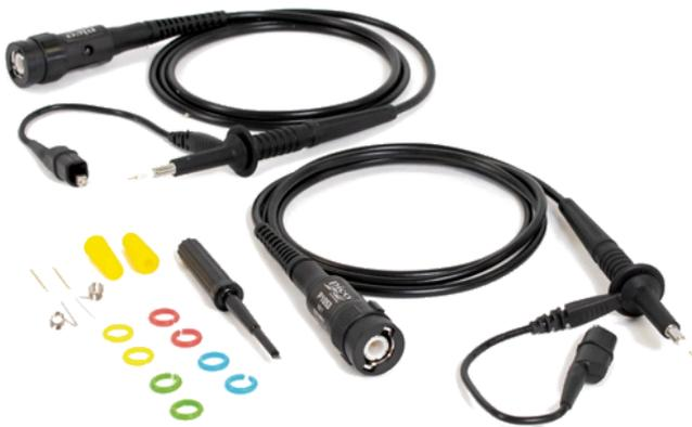
TA562 (P1053) 探頭（雙包裝）是一款高性能的示波器探頭，具備 10:1 衰減比和 500 MHz 頻寬。這款小巧的探頭非常適合現場維修與開發環境使用，因其纖細的 3.5 mm 探頭尖端外殼直徑，能在密集的 SMT 電路中提供出色的可視性，結合了優異的性能、小巧的體積與多功能性，對於在嚴苛應用中工作的示波器使用者來說，是一款極具吸引力的選擇。
