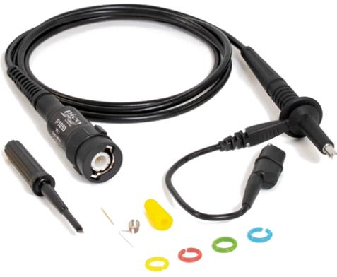
TA561 是 Pico 專為 PicoScope 3000E 系列設計的一款 500MHz 被動式示波器探頭，具備固定 10:1 衰減比，採用 BNC 接頭，探針線徑僅約 3.5mm，適合高密度 SMT 電路測量。
