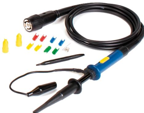
TA536 探頭是一支針對 350 MHz 頻段量測專門設計的高頻被動式探頭，具備峰值為 600 V 峰-峰 的量測能力。與 TA386 (200 MHz) 相比，TA536 提供更高頻寬、更快上升時間、原生支援 PicoScope 3000E 系列，且配備彈簧式接地配件，支援 1:1 與 10:1 衰減切換，結構設計聚焦在提高耐用性、使用便利性與高頻性能。非常適合高頻訊號分析、射頻通訊、精密電子量測用途。
