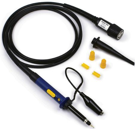
TA375 是一支通用型被動示波器探頭，最高頻寬 100 MHz，支援 1:1 / 10:1 可切換衰減，使用 BNC 接頭，適用於 PicoScope USB 示波器及其他品牌常見示波器。結構堅固、性價比高的 100 MHz 被動探頭，能快速切換衰減模式、方便維護替換配件，且無需供電，即插即用。適合工程師或學生使用於汽車通訊（如 CAN/FlexRay）與一般電子測試場合。如需更高頻寬，可參考 TA386（200 MHz）或 TA536（350 MHz）型號。
